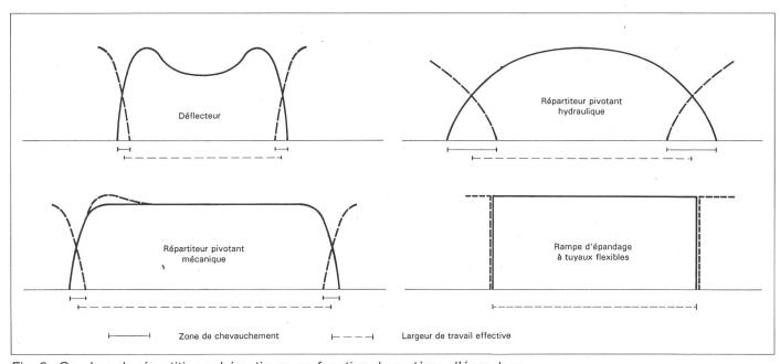
Fig. 6: Courbes de répartition schématiques en fonction du système d'épandage.
