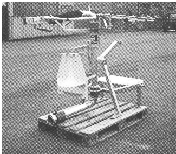
Fig. 1: Banc d'essai pour la mesure de la répartition latérale. Les essais avec du lisier demandent beaucoup de travail, car l'installation doit être déplacée après chaque passage.
