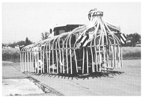
Fig. 15: Les rampes d'épandage à tuyaux flexibles étant en général utilisées sur plusieurs exploitations, il convient de les équiper d'un signalement particulièrement efficace. La sécurité n'est assurée lors du transport que si les bras sont repliés vers l'avant.
