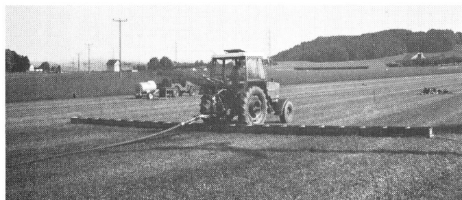
Fig. 1: Banc d'essai pour la mesure de la répartition latérale. Les essais avec du lisier demandent beaucoup de travail, car l'installation doit être déplacée après chaque passage.
