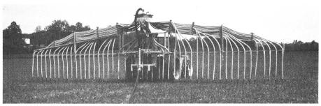
Fig. 5: Rampe d'épandage à tuyaux flexibles avec une largeur de travail de 12 m et 48 tuyaux d'épandage (Vogelsang). Les caractéristiques de cet engin se situent au niveau de la distance d'épandage très rapprochée du sol et de la constance de la largeur de travail, ce qui évite les problèmes de chevauchement.
