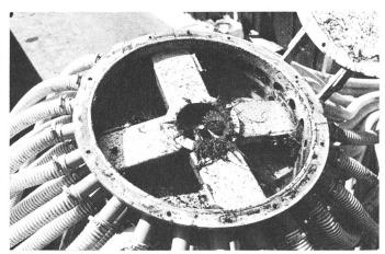
Fig. 14: Vue à l'intérieur du rotor d'une rampe d'épandage à tuyaux flexibles (E + H): L'exactitude de répartition peut être compromise par la présence de matières dures tels que le foin, la paille longue ou les morceaux de bois. Etant insuffisament hachés, ces matières obstruent les ouvertures.
