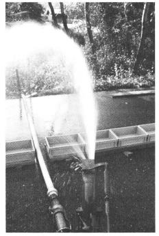
Fig. 10: Répartition asymétrique avec le répartiteur pivotant: la déviation latérale du jet provoque dans les cas extrêmes une déviation dans le sens de la largeur jusqu'à 5 m de différence entre la gauche et la droite.
