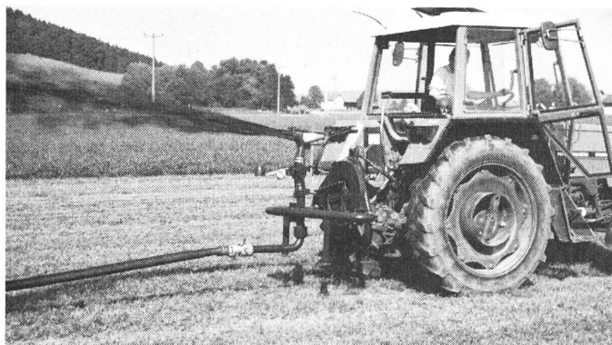
Fig. 3: Répartiteur pivotant entraîné par la prise de force (Meier-Perfekt). Pour les répartiteurs à entraînement par courroie trapézoïdale, la buse pivote horizontalement et verticalement. La fréquence de pivotement est réglée par le régime de la prise de force.
