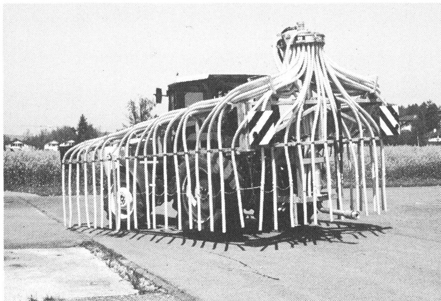
Fig. 15: Les rampes d'épandage à tuyaux flexibles étant en général utilisées sur plusieurs exploitations, il convient de les équiper d'un signallement particulièrement efficace. La sécurité n'est assurée lors du transport que si les bras sont repliés vers l'avant.
