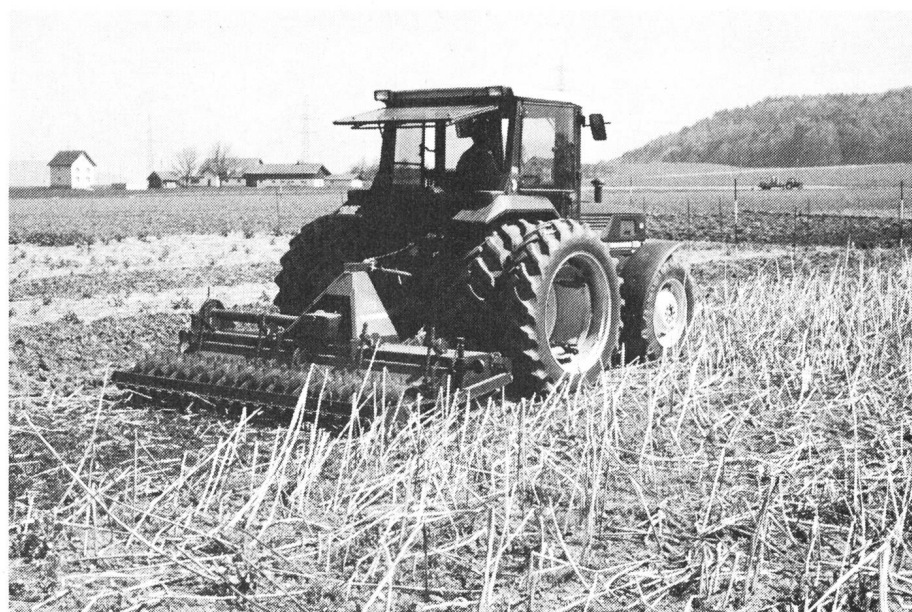
Fig. 3: Travailler le sol sur toute sa surface pour effectuer un semis sous litière (ici avec une herse rotative à axe horizontal dans des tournesols) représente une solution avantageuse, ne nécessitant pas de machines spéciales.
