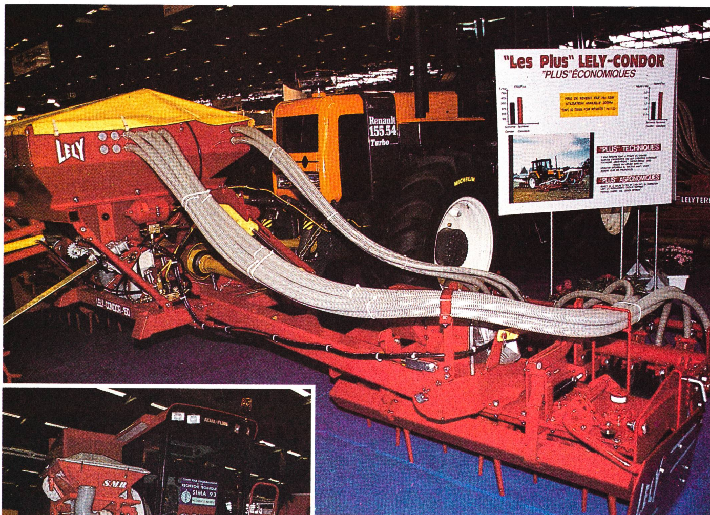
Gigantisme: Semoir combiné à une herse rotative avec une unité gauche et une unité droite permettant soit de labourer (avec adjonction d'une charrue), herser et semer, soit de préparer un lit de semences de six mètres de large (sans semoir et avec une herse rotative supplémentaire), le tout en un seul passage.
