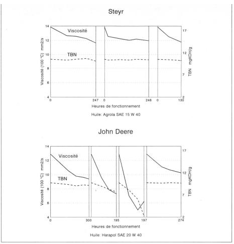
Fig. 9: Dilution de l'huile du moteur des tracteurs durant 3, resp. 4 intervalles de vidange.
