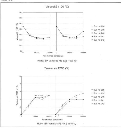
Fig. 10: Dilution de l'huile du moteur de cinq bus durant deux intervalles de vidange.
