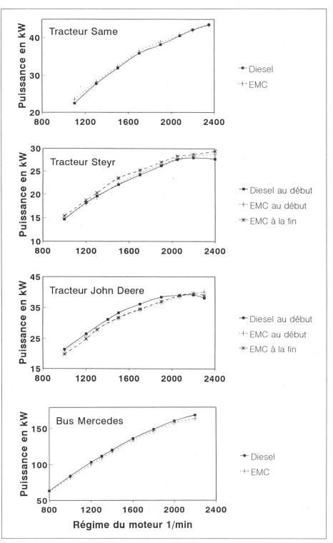
Fig. 4: Puissance du moteur au diesel et à l'EMC.
