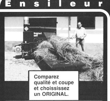
L'ensileur ORIGINAL trait d'union entre l'autochargeuse et le silo. Eprouvé dans des centaines d'exploitations. Matériel de première qualité. Utilisable pour toutes les sortes de fourrage. Coupe de 3 à 192mm.
