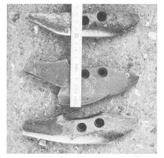
Les socs usés seront remplacés ou réparés par un brasage puis affûtés. Le brasage destiné aux réparations fait partie intégrante des cours de soudure électrique, enseignés au centre de Grange-Verney.
