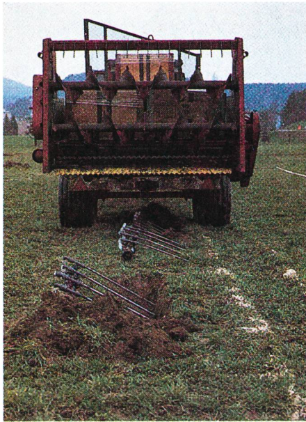
Épandeuse traditionnelle passant sur les sondes «Bolling». Ces sondes se composent d'un tuyau en PVC rempli d'eau: à l'une des extrémités, on y a fixé un manomètre tandis qu'à l'autre se trouve une ballon de mesure.
