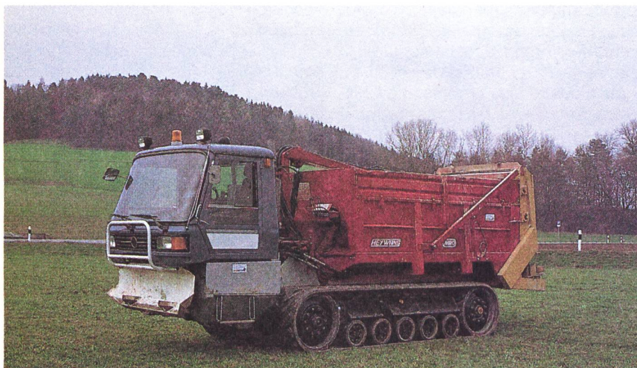
Véhicule à chenilles équipé d'une bande en caoutchouc de Caterpillar, conçu par la maison Salzmänn SA, Boll.
