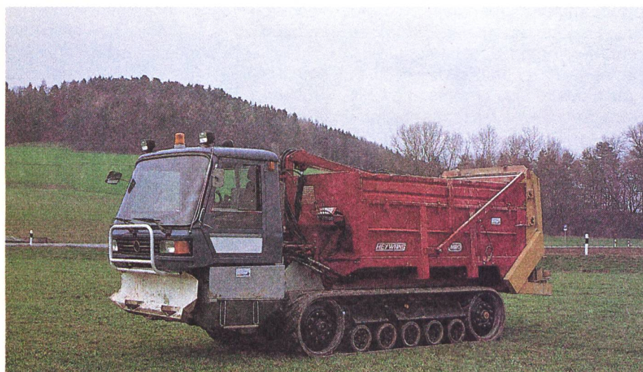
Véhicule à chenilles équipé d'une bande en caoutchouc de Caterpillar, conçu par la maison Salzmann SA, Boll.
