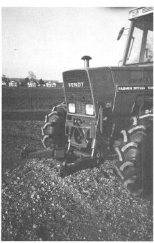
Les bras du relevage frontal doivent pouvoir se replier ou se démonter avec une manutention réduite en cas de non utilisation de longue durée. Le triangle du 3-points de l'attelage rapide diminue le risque d'accident. Une prise de force frontale bien intégrée et suffisamment longue facilite l'utilisation des arbres de transmission.
