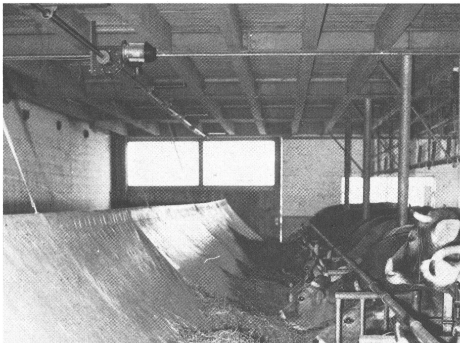
Fig. 4: Avec moteur central à engrenage à vis sans fin autobloquant, relevage à rubans et déclenchement en fin de course (Maison Sitrag, CH-8514 Bänikon-Bissegg).
