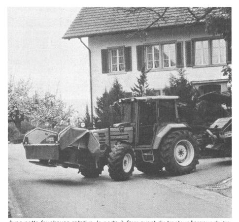
Avec cette faucheuse rotative, le porte-à-faux avant du tracteur l'argeur de travail 2.60 m) mesure 3.60 m. Les panneaux jaunes et noirs (de 10 cm de largeur) sont munis de catadioptres blancs à l'avant. Ces derniers auront une surface de 40 cm² au minimum. La loi autorise aussi les revêtements réfléchissants d'une surface minimale de 100 cm². Les catadioptres seront fixés à une distance du sol de 40 à 90 cm.
