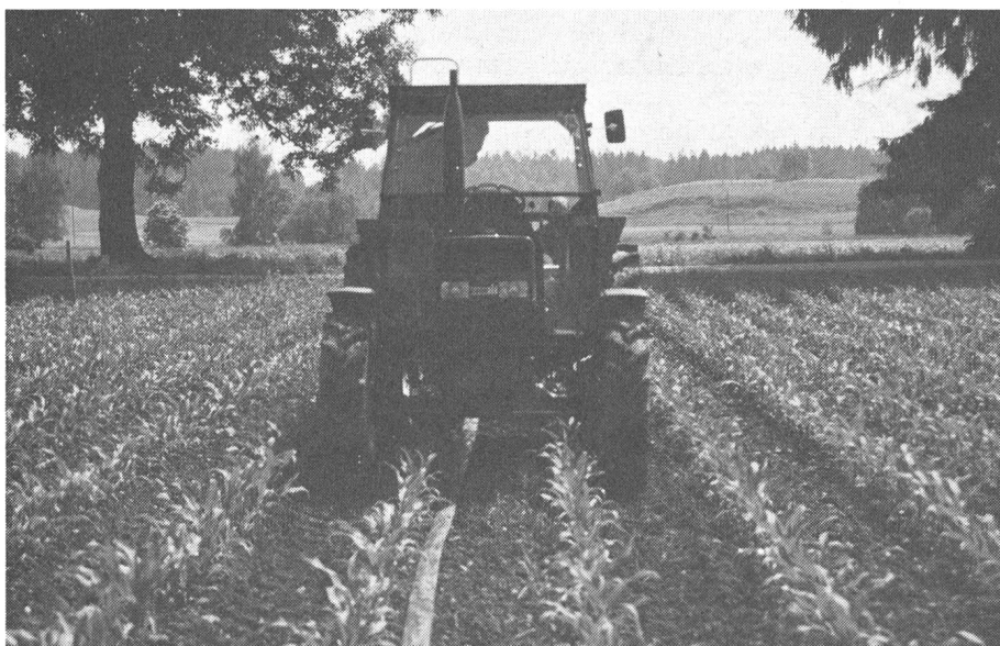
Fig. 5: Lorsque l'on travaille avec des tuyaux en PVC, le distributeur pivotant retire le tuyau entre les lignes de maïs au fur et à mesure de l'épandage.
