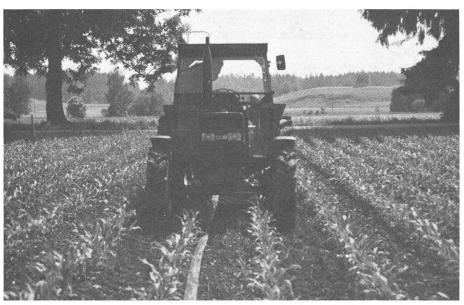
Fig. 5: Lorsque l'on travaille avec des tuyaux en PVC, le distributeur pivotant retire le tuyau entre les lignes de maïs au fur et à mesure de l'épandage.
