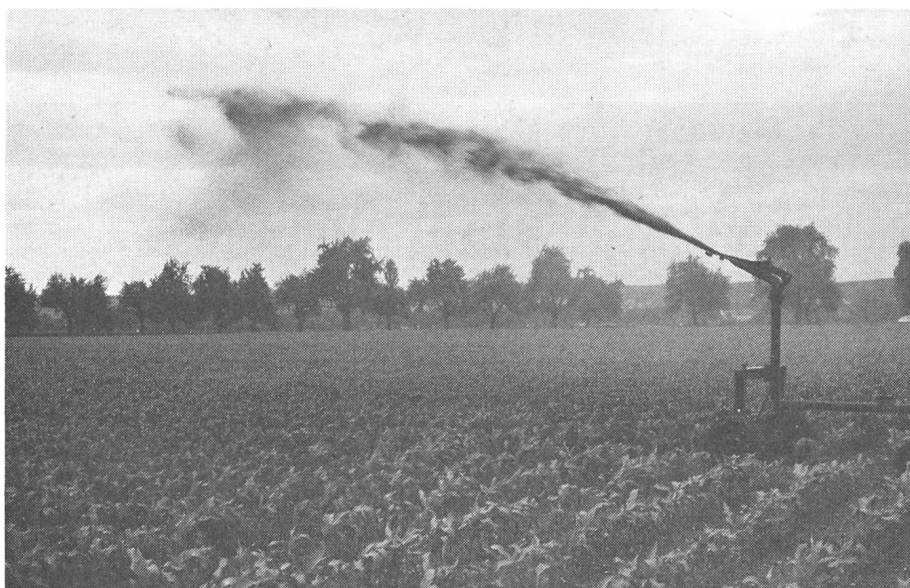
Fig. 6: Grâce à sa grande largeur de travail, l'arroseur automatique offre une capacité de surface élevée. Son utilisation n'est toutefois pas recommandée à proximité d'habitations et lorsqu'il y a du vent (dérive, émissions d'odeur, distribution peu exacte).
