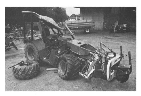
agricoles, j'ai pu vérifier qu'il est préférable de ne pas percer l'arceau dans le but d'y fixer des supports pour rétroviseurs ou autres éléments qui atténueraient son efficacité. Peter Läuchli, Netstal GL
