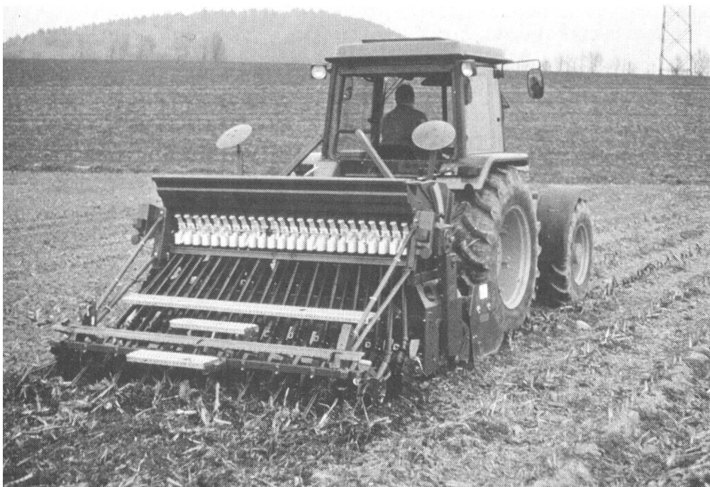
fig. 1. La combinaison de la herse rotative à axes verticaux et du semoir, d'une largeur de 2,5 m et d'un poids de 1538 kg a un rendement horaire d'environ 1 ha/h. Cette combinaison d'outils intelligemment conçue, permet de réaliser un nivellement du sol et un placement régulier des grains même dans des conditions difficiles, tels résidus de récoltes en abondance, sols pierreux ou durcis en surface.
