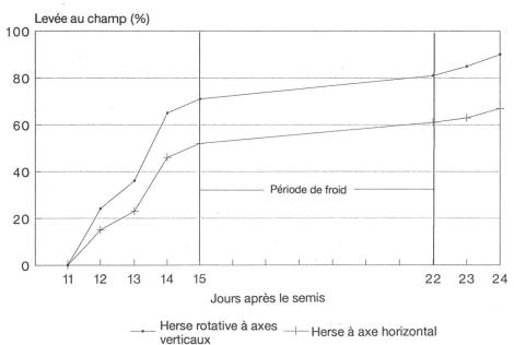
des a démontré qu'une meilleure levée et donc un meilleur peuplement à la récolte était obtenu pour les pois protéagineux en utilisant la combinaison du semoir avec herse rotative à axes verticaux, comparé à la combinaison équipée de la traditionnelle herse rotative à axe horizontal (fig. 7). Fort de
