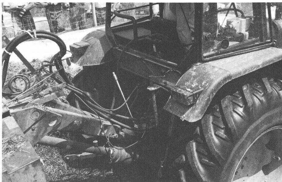
Timon réglable à l'autochargeuse: utile sur les surfaces accidentées, les pentes ainsi que sur la surface irrégulière de l'ensilage (en silo-tranchée).
