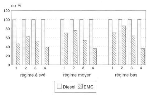
pression dans la pompe d'injection et une quantité volumétrique injectée plus importante. La différence restante entre 12% de consommation en plus, particulièrement à régime 3 élevé, et 13% de différence de valeur calorifique indique finalement un rendement légèrement meilleur du biodiesel.
