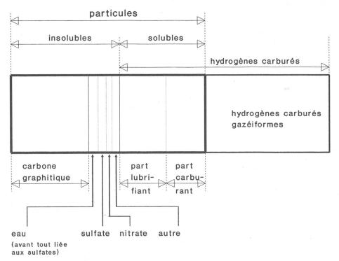
carbone et l'hydroxyde de carbone se transforment chimiquement par contact avec un revêtement de platine. Il s'agit d'une oxydation qui n'abîme pas ce revêtement. Ce processus se déroule dans le cas du soufre, mais alors avec des effets négatifs car le sulfate et l'acide sulfurique qui en résultent augmentent fortement la masse des particules.
