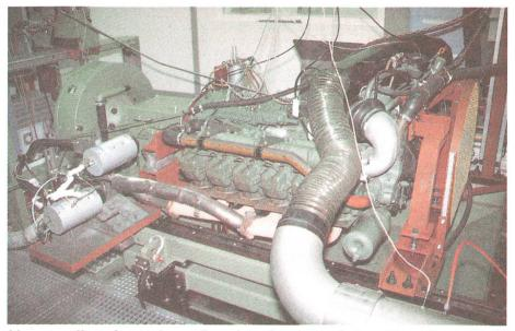
Mesures effectuées au banc d'essai sur le moteur du bus Mercedes avec différents systèmes de traitement des gaz d'échappement. Les résultats confirment une composition en particules du biodiesel toute autre. En raison de la teneur en fumée inférieure, de l'accroissement de la part de particules solubles et de l'absence de soufre, le biodiesel se révèle particulièrement bien adapté à l'utilisation d'un catalyseur.
