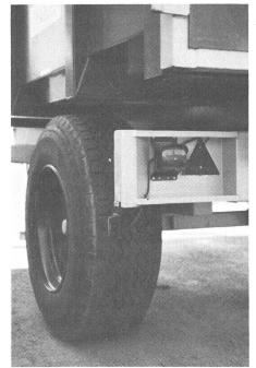
Montage de feux arrières et de clignoteurs, encastrés à la partie inférieure du châssis. Il est recommandé de monter les feux aux endroits situés le plus à l'extérieur du bord du véhicule.
