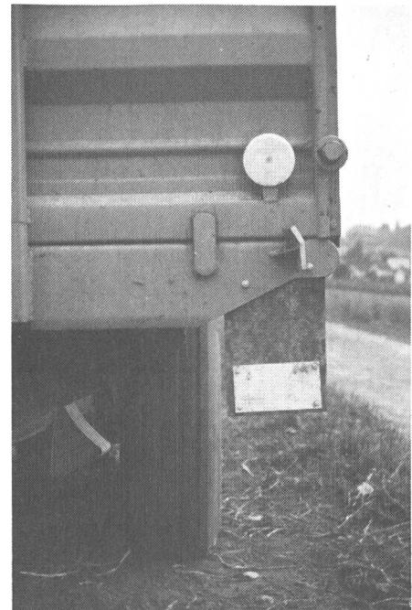
Dans la pratique, on constate souvent que les catadioptres avant blancs font défaut. On fixera alors des catadioptres avec revêtement réfléchissant et des réflecteurs sur un morceau de caoutchouc flexible ou sur tout autre surface synthétique.
