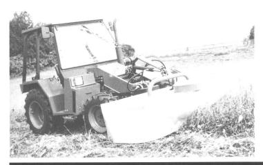
Centre de gravité bas Traction 4 roues enclenchable Direction assistée Construction compacte Boîte à vitesses synchr. Grandes roues arrière Relevage hydr. arrière de série
