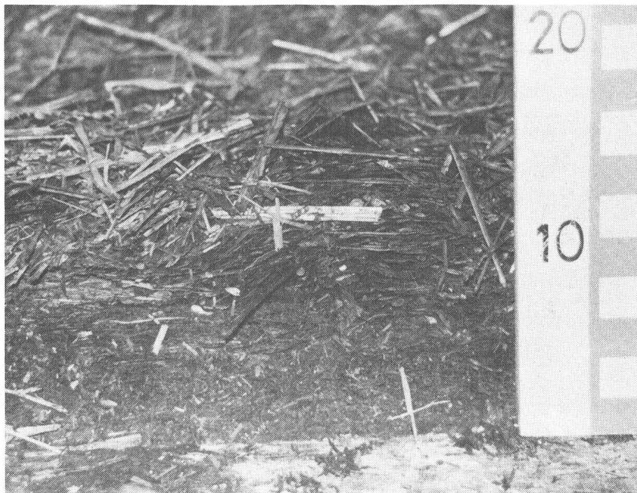
Fig. 4: Coupe du matelas de paille qui est compact dans sa partie inférieure, d'où un effet positif sur la souplesse et l'isolation thermique.
