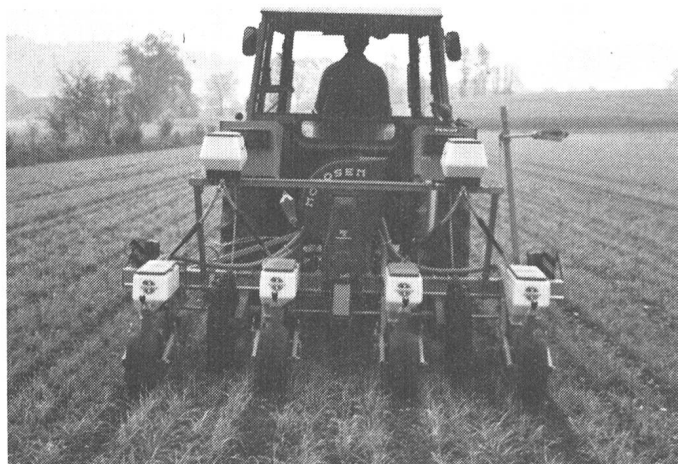
Fig. 5: Après destruction chimique d'une culture de seigle à titre d'engrais vert, le semis direct du maïs peut être effectué sur des sols exempts de traces également avec des semoirs monograines usuels, équipés de disques de coupe (à gauche). Les machines lourdes peuvent être utilisées de manière plus polyvalente (à droite).
