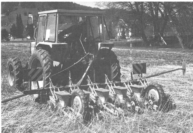
Fig. 1: Un équipement de semis direct avec disques de coupe doubles et rouleaux de réglage de la profondeur, des socs semeurs bien intégrés ainsi que des organes de terrage à disque garantissent un semis direct de betteraves (à gauche) et de maïs (à droite) exempts de bourrage.
