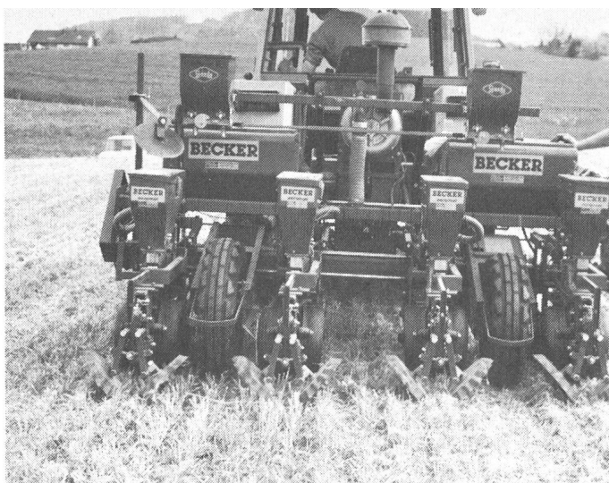
Fig. 6: Après broyage d'une culture de seigle à titre d'engrais vert, le semis direct du maïs nécessite des machines spéciales lourdes et coûteuses, ou alors un ameublissement localisé du sol, une préparation du lit de semences et un semis monograine usuel.
