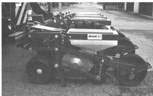
Fig. 2: Vue générale de la construction des semoirs examinés et de leur équipement pour le semis sous litière (à gauche: betteraves sucrières; à droite: maïs).
