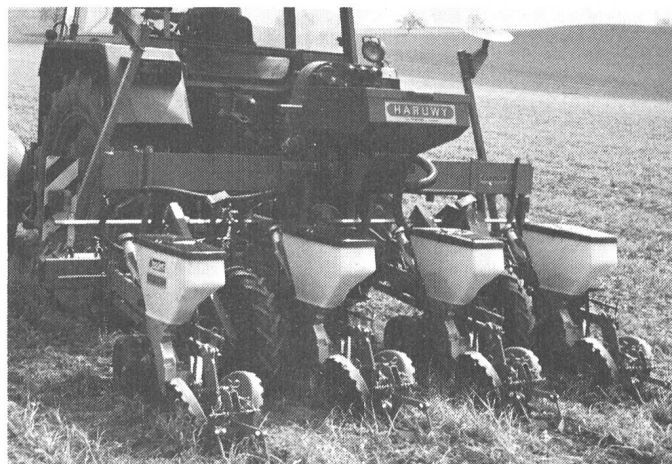
Fig. 5: Après destruction chimique d'une culture de seigle à titre d'engrais vert, le semis direct du maïs peut être effectué sur des sols exempts de traces également avec des semoirs monograines usuels, équipés de disques de coupe (à gauche). Les machines lourdes peuvent être utilisées de manière plus polyvalente (à droite).
