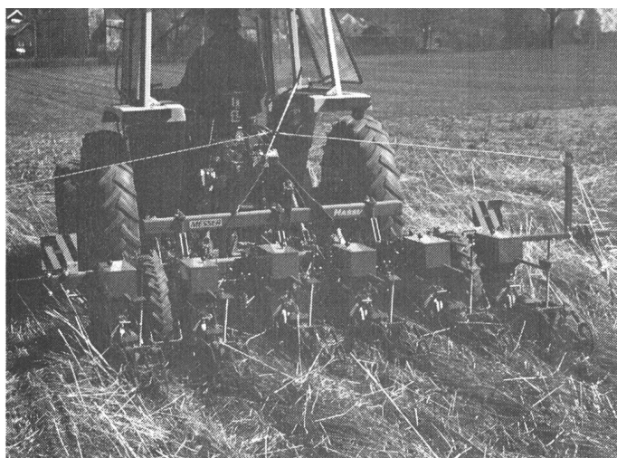
Fig. 3: Une couverture dense de moutarde pose des exigences élevées aux disques de coupe resp. d'évacuation et aux outils de recouvrement.
