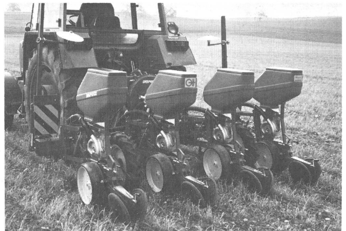
Fig. 1: Un équipement de semis direct avec disques de coupe doubles et rouleaux de réglage de la profondeur, des socs semeurs bien intégrés ainsi que des organes de terrage à disque garantissent un semis direct de betteraves (à gauche) et de maïs (à droite) exempts de bourrage.
