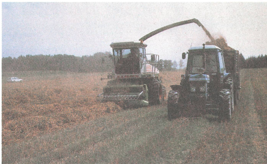
Ill. 2: Pour le hachage de la paille au champ, seules des machines équipées de détecteurs de métal ou d'extincteur d'étincelles devraient être utilisées. L'extincteur d'étincelles peut être monté sur la tuyauterie du souffleur également.
