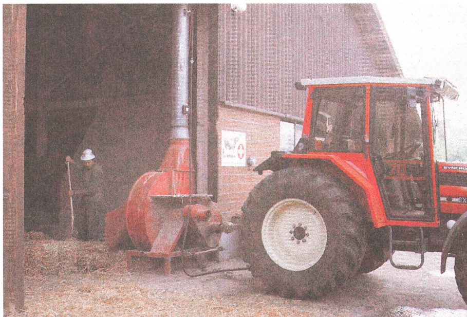
III. 1: Lors du hachage de paille dans la grange, le tracteur doit rester à l'extérieur. De plus, un tube équipé d'un extincteur d'étincelles comprenant détecteurs et buses d'extinction s'avère indispensable. Il détecte les étincelles et les neutralise en quelques fractions de secondes.
