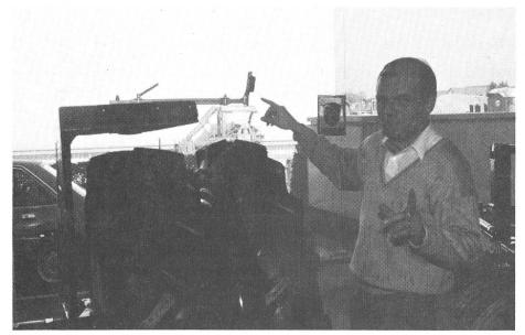
En ce qui concerne la signalisation et l'éclairage, le législateur prescrit (OCE art. 27, 49 et annexe 7): pour les véhicules dépassant la largeur de 2,10 m, il faut fixer des feux de gabarit à l'avant et à l'arrière à un intervalle max. de 10 cm de l'extrême bord du véhicule, si les clignoteurs arrières sont éloignés de plus de 10 cm. Fritz Schaad offre les feux de gabarit GS Posilux, extensibles et facilement réglables.
