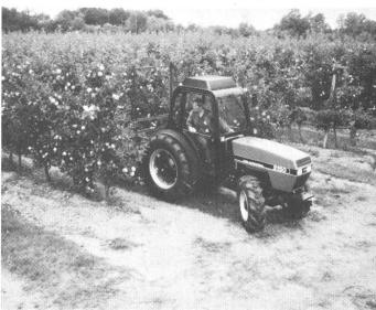
CASE-IH offre un programme complet de tracteurs destinés aux vergers et à la vigne, soit dans les catégories de 45 CV (33 kW) à 75 CV (55 kW). Ces tracteurs sont caractérisés par une maniabilité étonnante grâce à un braquage qui va jusqu'à 55° sur les modèles 4x4, ce qui donne un rayon de braquage de 3,5 m environ. Côté performance hydraulique, ces tracteurs sont équipés d'une pompe puissante (débit: 59 l/min). La
