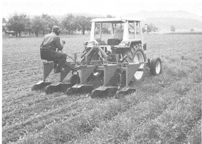
Josef Scheiwiller de Waldkirch, SG, a développé un outil pour le mulching d'après le principe de la tondeuse rotative. La machine présente un poids relativement peu élevé et un besoin de puissance réduit.
