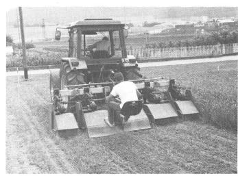
L'outil de fauche «mulching» interligne construit par W. Witzig est basé sur le principe de fléau. Il travaille à une grande vitesse de rotation. Depuis peu, cet outil peut être monté soit à l'avant soit à l'arrière du tracteur.
