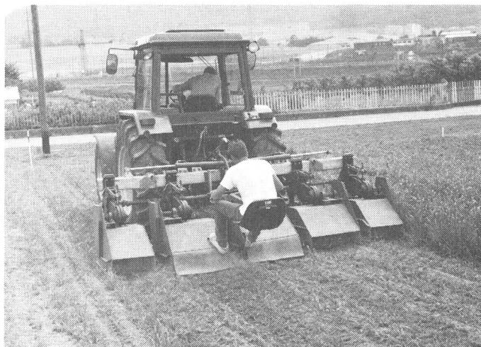
L'outil de fauche «mulching» interligne construit par W. Witzig est basé sur le principe de fléau. Il travaille à une grande vitesse de rotation. Depuis peu, cet outil peut être monté soit à l'avant soit à l'arrière du tracteur.
