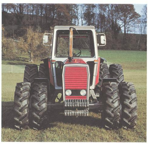
Un tracteur moderne équipé de 4 paires de roues jumelées Müller. La nouvelle technique de travail pour ménager le sol.
