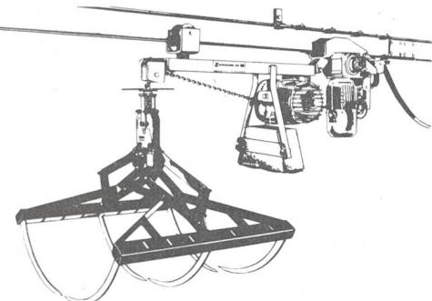
Voici la première griffe à fourrages commandée électroniquement pour la préparation du fourrage. Une seule pression sur un bouton et vous transportez le fourrage désiré. Sans changer de place et par simple réglage, vous pouvez choisir 4 postes de chargement sur le tas (sur la meule) et jusqu'à 15 postes de déchargement automatiques. Grâce à un nouveau système d'entraînement, des élévations de 30° (52%) ne posent aucun problème. C'est bien entendu une nouveauté Zumstein!
