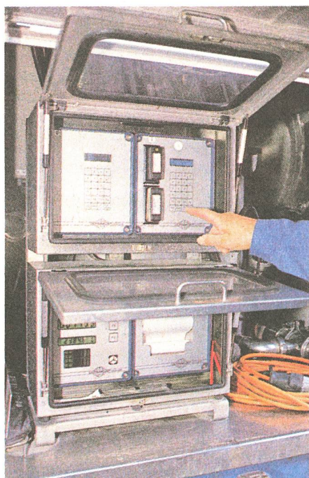
Informatique sur le camion-citerne: A droite en haut se trouvent les deux cassettes: celle du dessus renferment les données actuelles, celle du dessous mémorise les données des 10 derniers prélèvements (mesures). A droite, l'espace pour l'envoi manuel de données et d'ordre. En-bas, affichage numérique et à gauche, sur imprimante.
