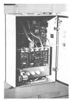
Fig. 2: Ondulateur SOLCON 3000
