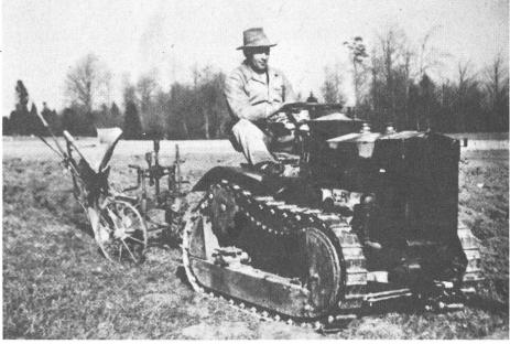
Puisqu'un axe de piston décalé avait endommagé la surface de la course du cylindre et que le spécialiste ne pouvait plus le réparer, F. Zweyacher l'échange contre une radio. D'innombrables heures sont nécessaires pour remettre ce tracteur en état de marche.
