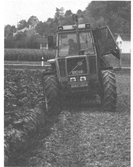
Fig. 5: Faut-il répéter le labour chaque année? Les roues du tracteur roulant dans le sillon, bien souvent humide, provoquent des dégâts de tassement.
