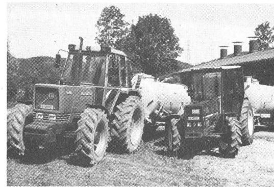
Fig. 6: Mécanisation plus lourde ou plus légère? Avec des conditions de travail au champ identiques (état d'humidité du sol) et pour les mêmes itinéraires techniques (travail du sol/ "Ameublissement du sol", fumure, etc.), c'est le procédé plus léger qui permet d'atteindre les meilleurs rendements à long terme.
