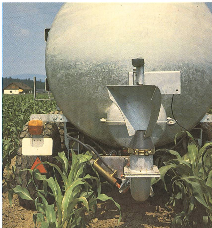
Le répartiteur orientable Elomax (Armatec), présenté par Mathys AG, Huttwil, convainc par son épandage très précis.
