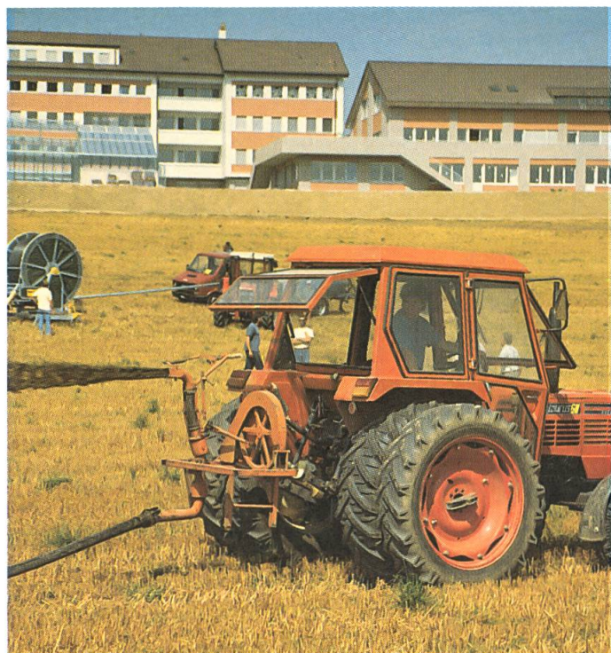
Le répartiteur orientable (Fankhauser). Une coupe trop étroite de la conduite d'amenée augmentera la résistance due au frottement à l'intérieur du tuyau de façon surproportionnelle.
