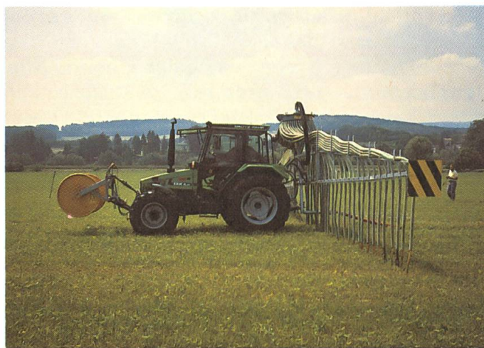
A la démonstration de Zoug, ce système d'épandage a été présenté comme élément supplémentaire à l'hydraulique du tracteur; l'amenée du lisier est faite par la tuyauterie.
