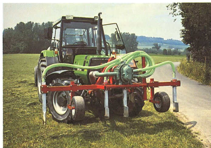
Aspergeur de lisier monté sur tracteur avec une citerne à pression conventionnelle (Vakuummat, Somag AG, Egnach)
