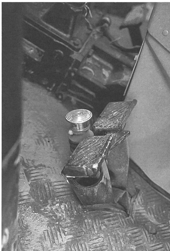
La soupape de guidage «Baumgartner», vissée sur la pédale de frein ne la haussera que de 1,5 cm. Il faut cependant suffisamment de place afin que la soupape de guidage ne touche le sol, ce qui gênerait le jeu de la pédale.
