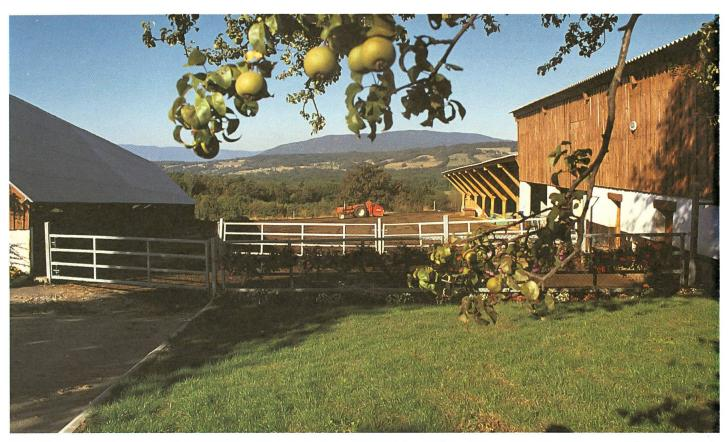
Une cour de ferme spacieuse comptant une aire de mouvement de 10 m<sup>2</sup> et une surface de repos de 5 m<sup>2</sup> par vache. A gauche, la place d'affouragement avec une fourragère centrale. A droite, l'aire de repos sur litière profonde et à l'extrême droite, la salle de traite, équipée d'un distributeur de fourrage.
