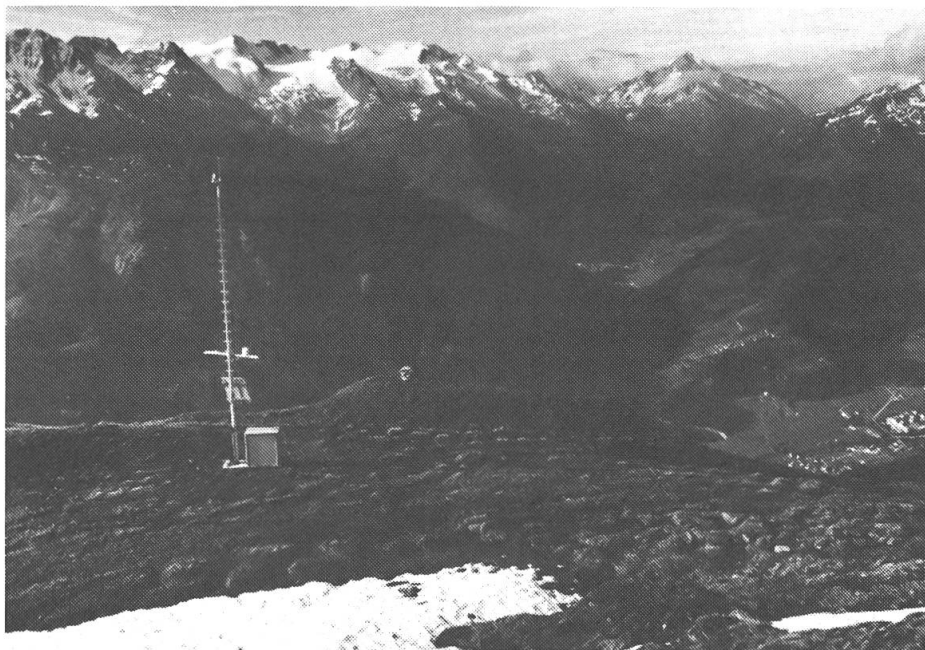
Le projet «Lavinox» de Disentis est fondé sur une station de mesures automatiques qui analyse, grâce à des sondes, la neige et les données météorologiques aux endroits à risques avalanches.
