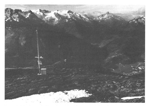
Le projet «Lavinox» de Disentis est fondé sur une station de mesures automatiques qui analyse, grâce à des sondes, la neige et les données météorologiques aux endroits à risques avalancheux.
