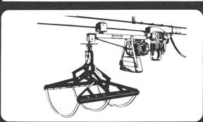
Voici la première griffe à fourrages commandée électroniquement pour la préparation du fourrage. Une seule pression sur un bouton et vous transportez le fourrage désiré. Sans changer de place et par simple réglage, vous pouvez choisir 4 postes de chargement sur le tas (sur la meule) et jusqu'à 15 postes de déchargement automatiques. Grâce à un nouveau système d'entraînement, des élévations de 30° (52%) ne posent aucun problème. C'est bien entendu une nouveauté Zumstein!
