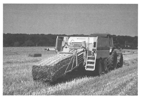
Fig. 8: Les presses à grosses balles cubiques sont encore rares actuellement. Y aurat-il des changements dans le futur?
