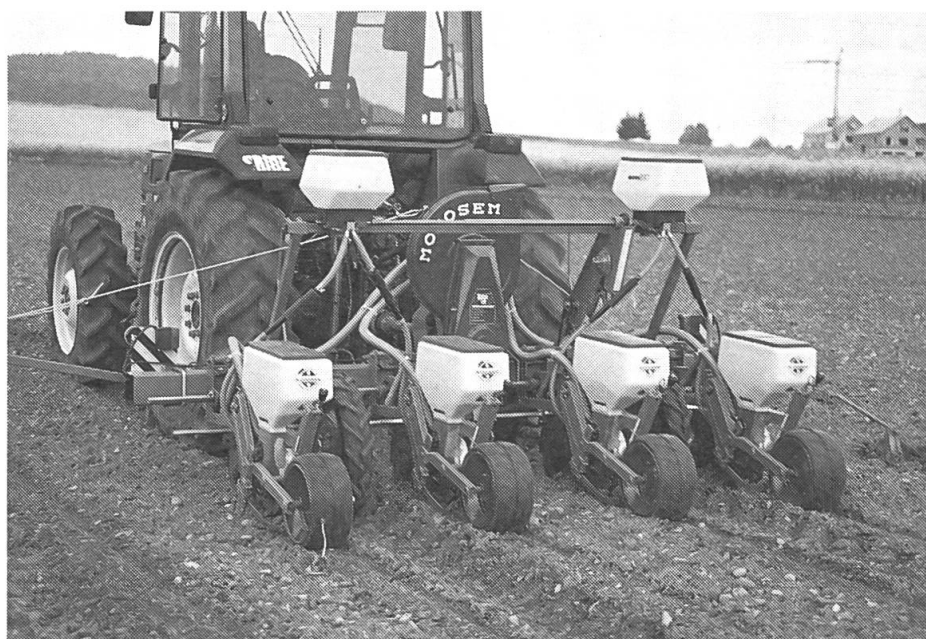
Fig. 4: Pour les semoirs pneumatiques, un seul disque permet de semer tous les calibres de graines de maïs, sans endommager les semences. Le montage d'un granulateur est possible chez tous les fabricants.
