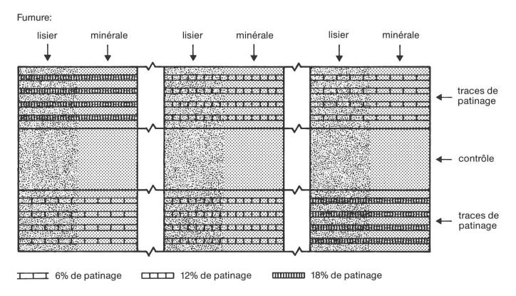
Fig. 3: Schéma du terrain d'essai avec les differentes répétitions: les quatre variantes de patinage (6%, 12%, 18% et contrôle) et les deux variantes de fumure (lisier, engrais minéral) ont donné un total de 18 parcelles de 5 x 3 m.
