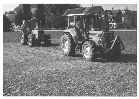
Fig. 2: Installation de patinage: un tracteur de traction de 3 t est retenu par un tracteur freineur de façon a provoquer le pour-centage de patinage voulu (6, 12, 18%).
