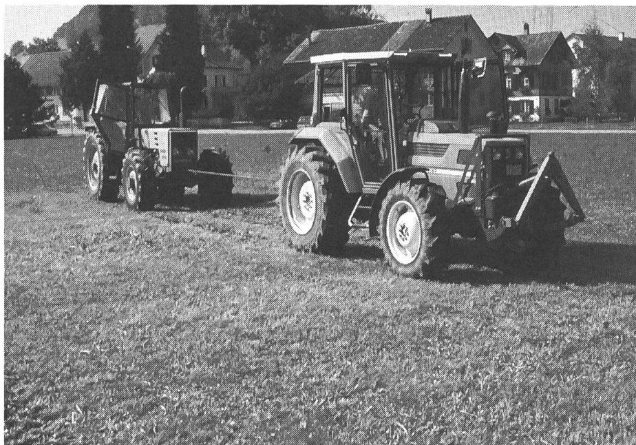
Fig. 2: Installation de patinage: un tracteur de traction de 3 t est retenu par un tracteur freineur de façon à provoquer le pourcentage de patinage voulu (6, 12, 18%).
