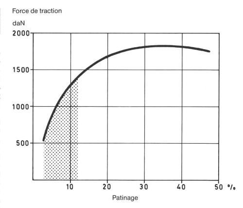
Fig. 4: Force de traction des pneus AS sur une prairie en fonction du patinage (adapté d'après Heine, Hohenheim). En dessous de 12% de patinage, l'enracinement n'est pas arraché par les crampons. Ceci permet d'éviter dans une large mesure la souillure du fourrage. Il n'est toutefois pas possible d'exploiter de cette façon la force de traction maximale.
