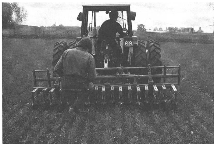
Fig. 4: L'outil de sarclage à socs ne détruit que les adventices poussant dans l'entre-ligne. L'efficacité du travail sera sensiblement améliorée par le passage de la herse étrille en complément. Il est avantageux d'utiliser un tracteur léger avec roues jumelées (pour le premier passage) et une pression basse dans les pneumatiques de l'ordre de 0,6 bar.
