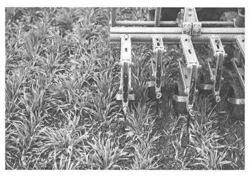
Fig. 4: L'outil de sarclage à socs ne détruit que les adventices poussant dans l'entre-ligne. L'efficacité du travail sera sensiblement améliorée par le passage de la herse étrille en complément. Il est avantageux d'utiliser un tracteur léger avec roues jumelées (pour le premier passage) et une pression basse dans les pneumatiques de l'ordre de 0,6 bar.
