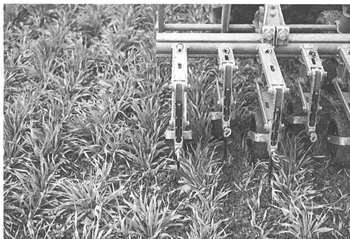
Fig. 4: L'outil de sarclage à socs ne détruit que les adventices poussant dans l'entre-ligne. L'efficacité du travail sera sensiblement améliorée par le passage de la herse étrille en complément. Il est avantageux d'utiliser un tracteur léger avec roues jumelées (pour le premier passage) et une pression basse dans les pneumatiques de l'ordre de 0,6 bar.
