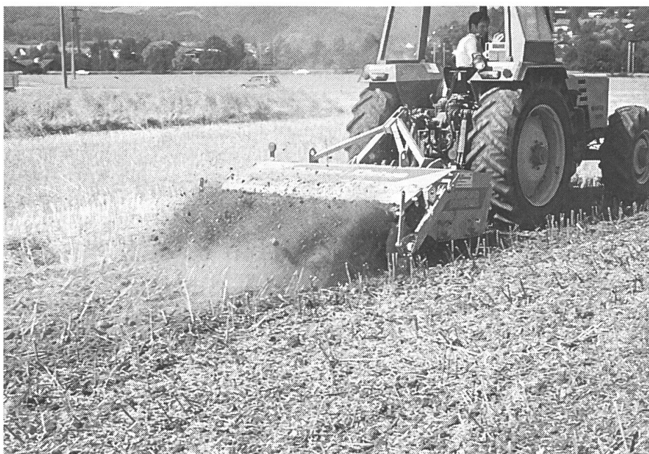
Fig. 3: Le Dyna-Drive assure un déchaumage efficace à la profondeur voulue. En comparaison avec une herse à bèches roulante à 3 rangées sur un sol limoneux, il a permis de faire lever plus du double (217%) de repousses de colza. Grâce à un semoir à céréales ou à petites graines monté sur l'appareil, entraîné par une roue à pneu (voir Fig. 5), il est possible lors d'un seul passage de mettre en place la culture suivante.
