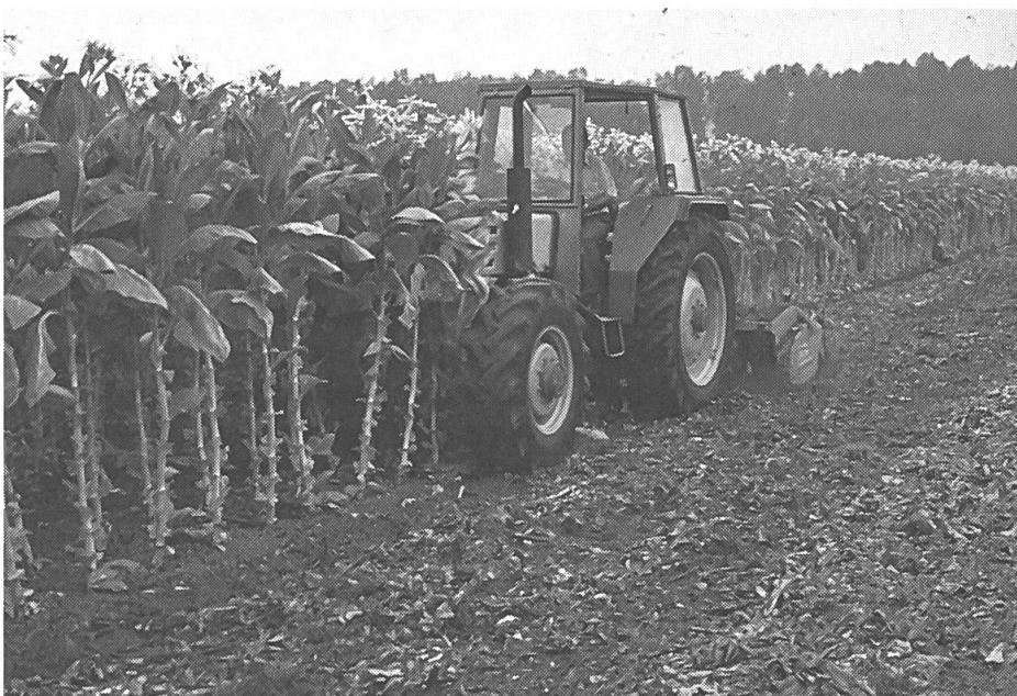
Fig. 4: Sans risques de bourrages, de grandes quantités de résidus végétaux peuvent être mélangées à la partie superficielle du sol: chaumes et paille, tiges de maïs, fumier, engrais verts. Pour détruire et enfouir les troncs de tabac, le Dyna-Drive demande la moitié du temps qu'exige une herse rotative à prise de force.
