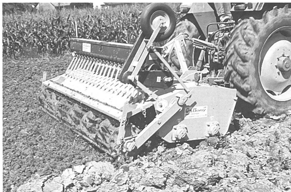
Fig. 5: Dans de grandes exploitations, le Dyna-Drive est souvent utilisé sur le labour pour aplanir et égaliser le sol.
