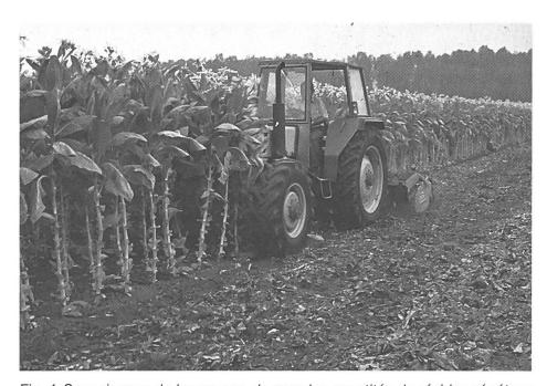
Fig. 4: Sans risques de bourrages, de grandes quantités de résidus végétaux peuvent être mélangées à la partie superficielle du sol: chaumes et paille, tiges de maïs, fumier, engrais verts. Pour détruire et enfouir les troncs de tabac, le Dyna-Drive demande la moitié du temps qu'exige une herse rotative à prise de force.
