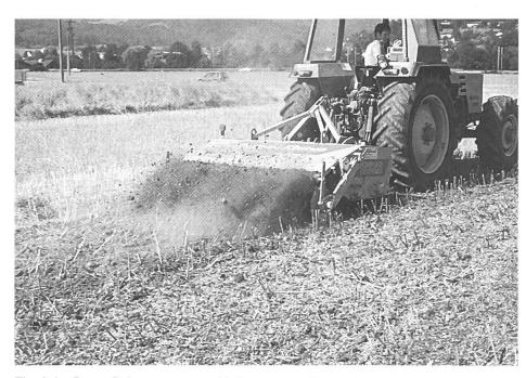
Fig. 3: Le Dyna-Drive assure un déchaumage efficace à la profondeur voulue. En comparaison avec une herse à bêches roulante à 3 rangées sur un sol limoneux, il a permis de faire lever plus du double (217%) de repousses de colza. Grâce à un semoir à céréales ou à petites graines monté sur l'appareil, entraîné par une roue à pneu (voir Fig. 5), il est possible lors d'un seul passage de mettre en place la culture suivante.
