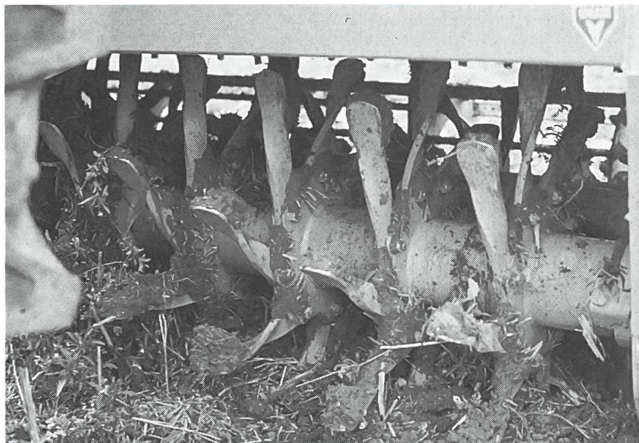
Fig. 2: Le Dyna-Drive est équipé de dents «cuillères» de 4 cm de largeur qui s'entrecroisent assurant un parfait autonettoyage. La profondeur de travail peut être réglée de 3 à 14 cm. Le rotor avant, par frottement avec le sol, entraîne au moyen d'une chaîne le rotor arrière à une vitesse 3 fois supérieure. Grâce au faible nombre de tours des rotors, la durée d'utilisation d'une dent se situe entre 400 et 1200 ha.
