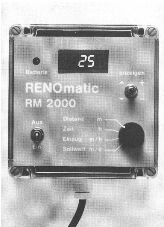
Fig. 6: Un tâteur rotatif enregistre la vitesse d'enroulement du tuyau et la compare à une norme, grâce à un système électronique. L'écart entre la valeur mesurée et la norme est corrigée par un régulateur monté sur la soupape by-pass.
