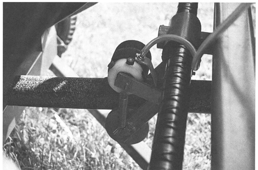
Fig. 6: Un tâteur rotatif enregistre la vitesse d'enroulement du tuyau et la compare à une norme, grâce à un système électronique. L'écart entre la valeur mesurée et la norme est corrigée par un régulateur monté sur la soupape by-pass.
