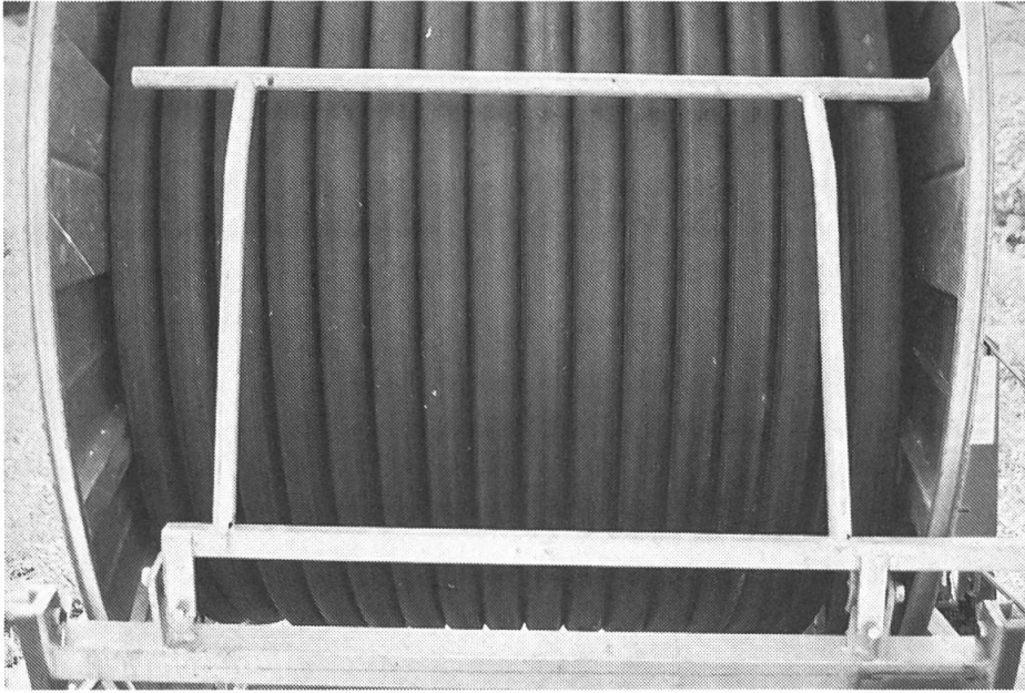
Fig. 5: Grâce à un tâteur, la modification de la vitesse d'enroulement, causée par l'augmentation du diamètre, est corrigée.
