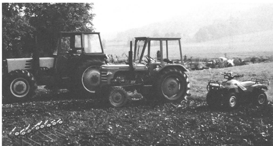
Fig. 3: Comparaison de différents véhicules lourds: la pression au sol dépend de la dimension des pneus et de la charge.
