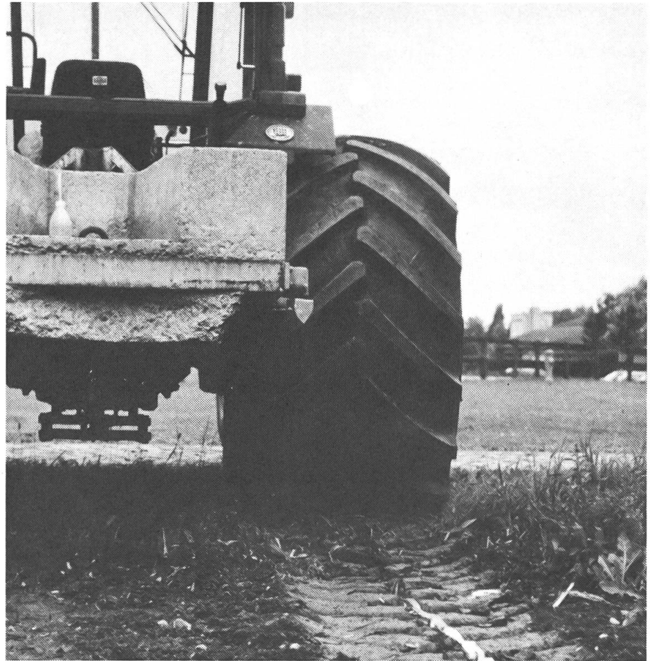
Fig. 2: La comparaison des pneus normaux avec les pneus larges démontre que ces derniers permettent de diminuer de plus de 30% la pression exercée au sol par le tracteur.
