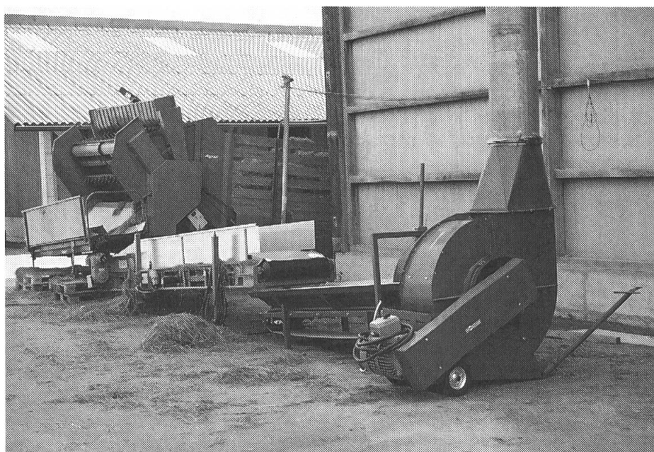
Fig. 3: Une balance sur tapis installée entre l'appareil de dosage et le tapis d'alimentation de la souffleuse a permis de relever le débit et la régularité du flux de fourrage.
