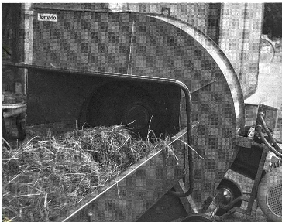
Fig. 1: Les grandes souffleuses sont aujourd'hui souvent équipées d'un appareil de dosage et d'un tapis d'alimentation. Dans les plupart des cas, un moteur de 15 kW est toutefois suffisant.
