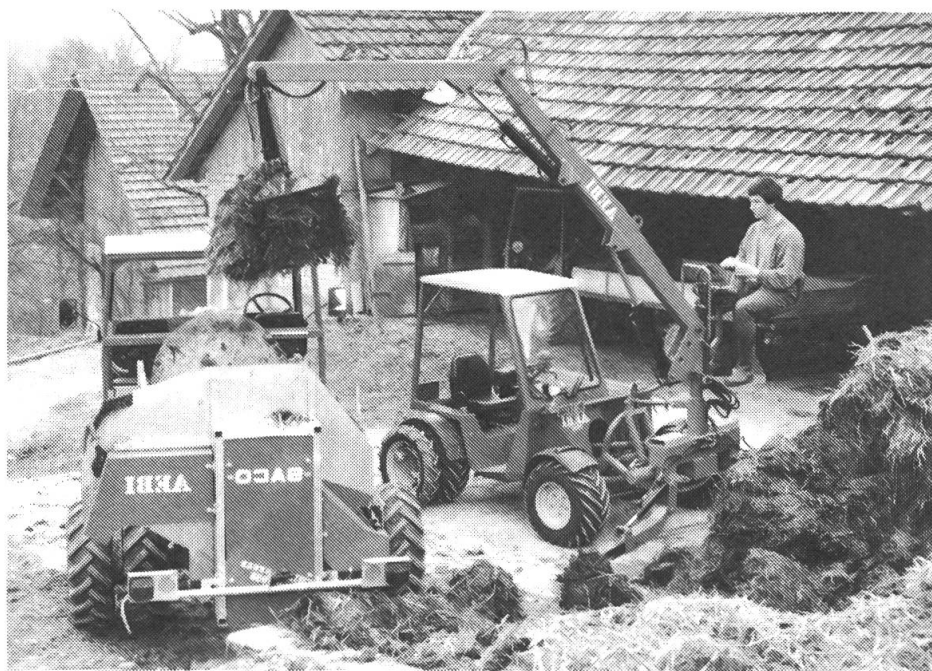
La nouvelle grue hydraulique Aebi HLT 400 pour montage à l'avant augmente considérablement les possibilités d'utilisation du Terratrak TT 33.
