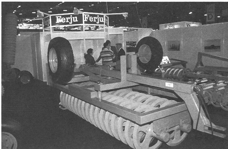
Une solution originale pour résoudre le problème du transport sur route des machines d'une largeur de travail supérieure à 3 m.
