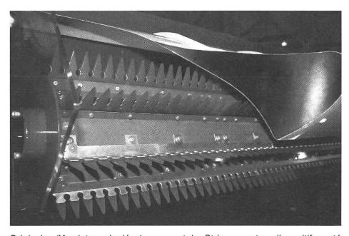
Originaire d'Angleterre, le développement du «Stripper» est un dispositif monté sur une moissonneuse-batteuse qui remplace les organes de coupe traditionnels et sépare les épis de la paille au moyen de 8 peignes élastiques fixés au rotor. La performance est ainsi accrue car la paille n'est plus acheminée par la moissonneuse-batteuse. Selon les indications des fabricants, ce système permet plus facilement le battage du blé même si les tiges sont encore vertes.
