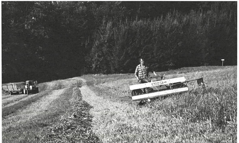
Fig. 1: motofaucheuse/autochargeuse: le système de récolte le plus répandu et le moins dommageable pour le sol, mais de loin pas le meilleur marché.
