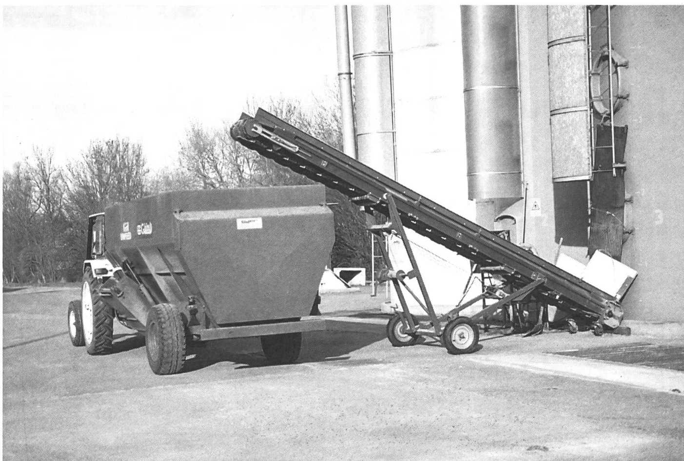
Une façon de procéder sûre: chargement indirect par un tapis roulant.
