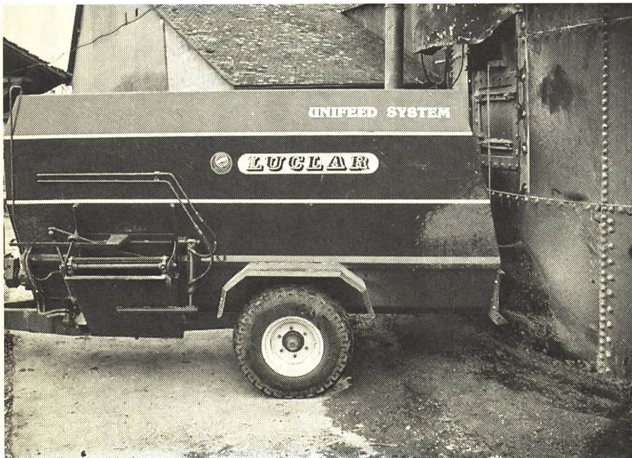
Dangereuse manière d'agir: le char mélangeur placé en marche arrière contre le silo.
