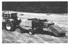
La presse à grandes balles rectangulaires Deutz-Fahr se distingue par sa construction sompacte et son poids de 2850 kg seulement. Aussi, des tracteurs à partir de 80 CV déjà suffisent pour l'actionner.
