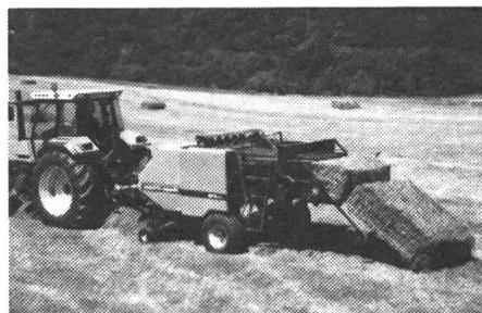
La presse à grandes balles rectangulaires Deutz-Fahr se distingue par sa construction compacte et son poids de 2850 kg seulement. Aussi, des tracteurs à partir de 80 CV déjà suffisent pour l'actionner.
