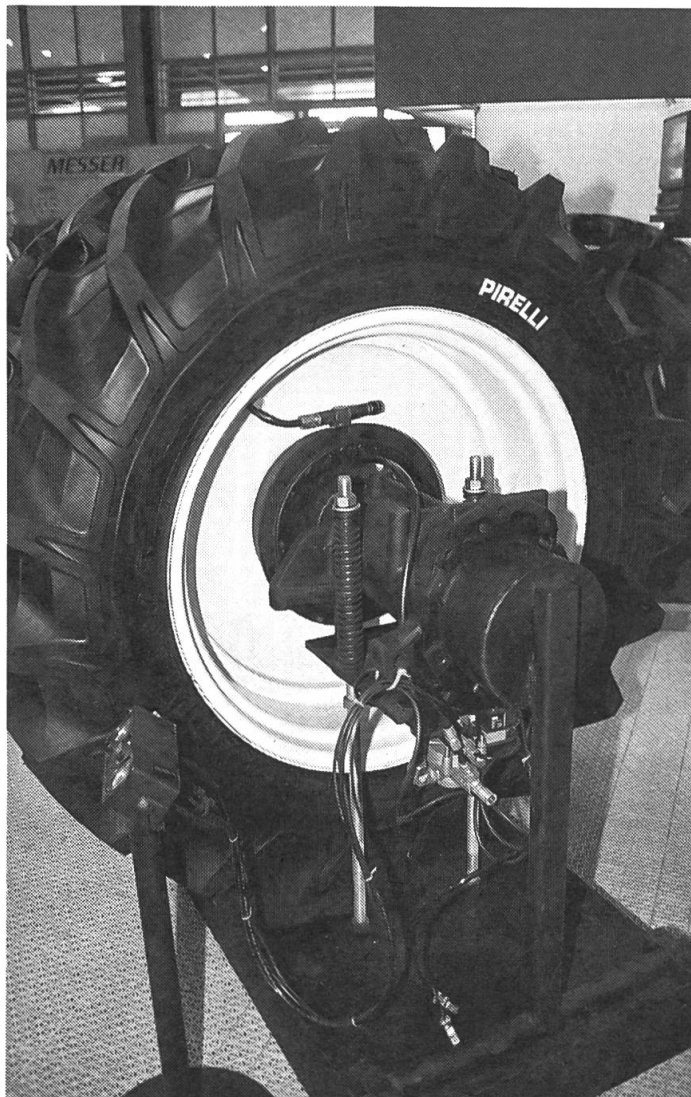
Règlage de la pression afin de réduire le tassement du sol. Stand de Gebr. Schaad, Subigen.
