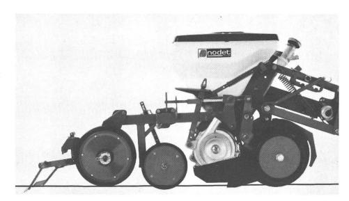
Semoir équipé avec un disque ouvreur et rouleau intermédiaire pour le semis sous-litière. (Photo: HARUWY)
