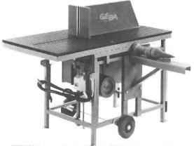
GEBA 85. La nouvelle scie circulaire GEBA. Puissante, solide, avec grande table de travail; possibilité de lui adjoindre une machine à fendre le hois
